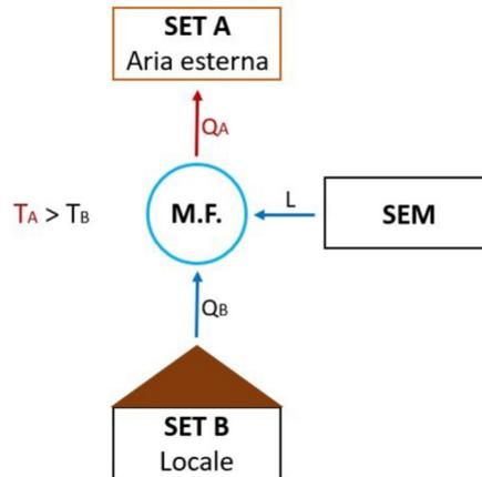
• **Pompa di calore** - il COP rappresenta il rapporto tra l'energia termica da fornire al SET a temperatura superiore e l'energia meccanica spesa:
